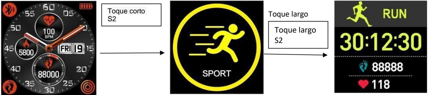
Mantenga presionado S2 para ingresar al modo de prueba, luego presione S2 para salir del modo de prueba
