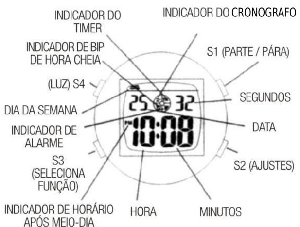
Mantenha o botão S1 pressionado para ver o mês e a data. Pressione o botão S4 para acender a iluminação do visor por 3 segundos. Pressione os botões S1, S2 e S3 simultaneamente para iluminar o visor, tocar o alarme e acender todas as indicações do visor.
