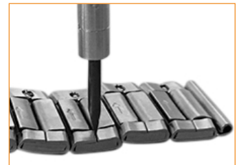
Enlever le maillon (détail) Retirar passador (detalhe)
