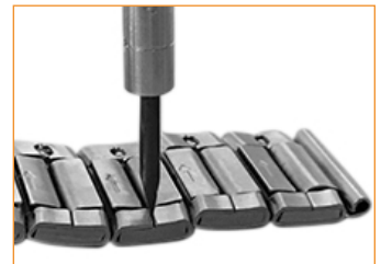
Enlever le maillon (détail) Retirar passador (detalhe)
